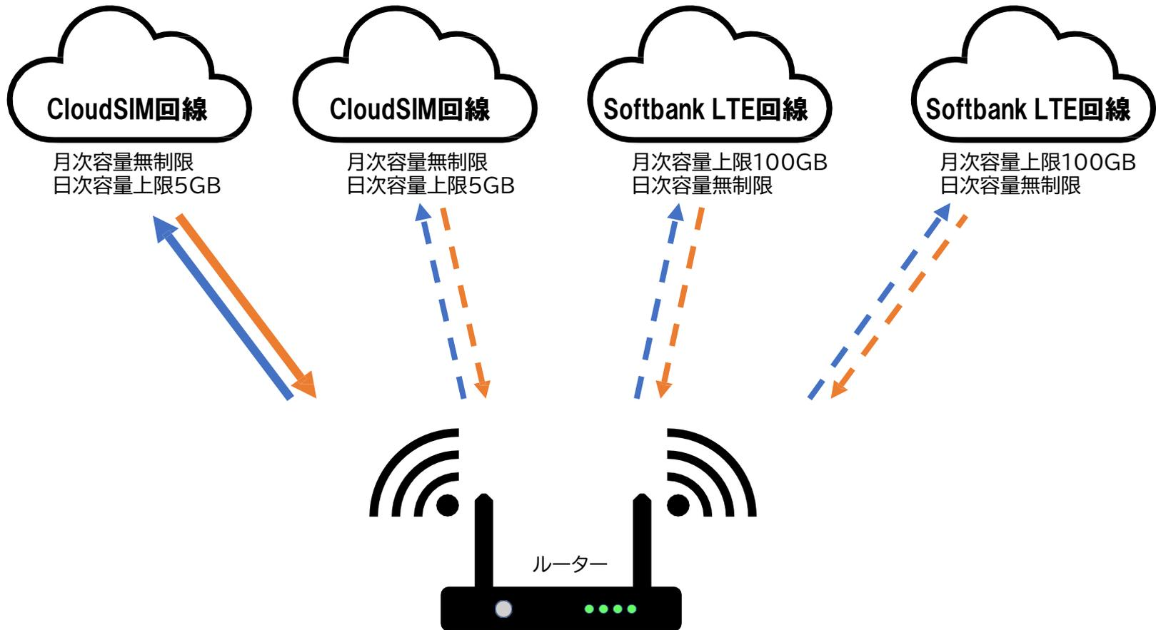
LTE SIM(docomo、Softbank、クラウドSIM)を複数枚搭載しています。複数枚のSIMを束ね1本の太い回線にすることで、通常のLTE回線と比較して大幅に通信速度がアップし、快適な通信が可能となります。
